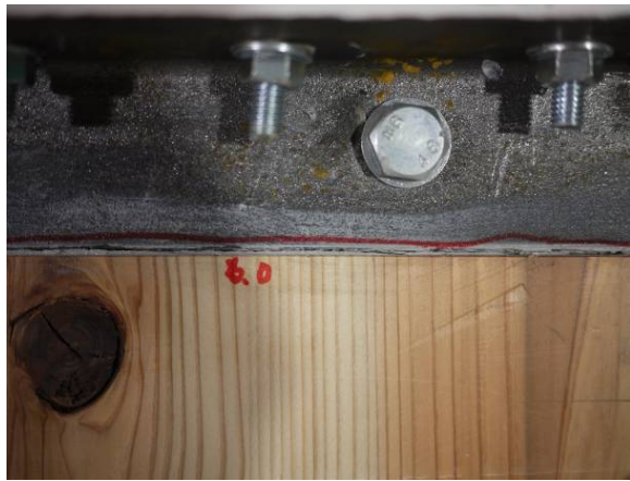
(c) CLT 上部と山形鋼の間のすべり
