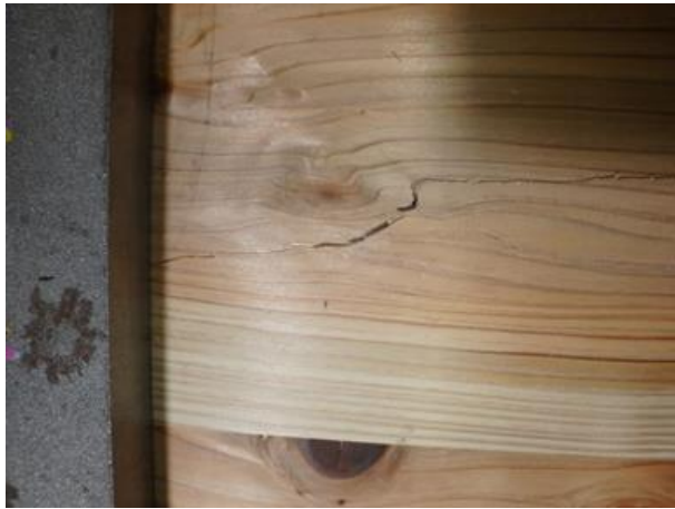
写真 3.3.3-3 試験体 S-01t 損傷状況 (ひび割れ部 2)
