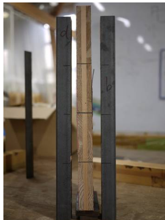
写真 3.3.3-5 L50-CLT 破壊性状
