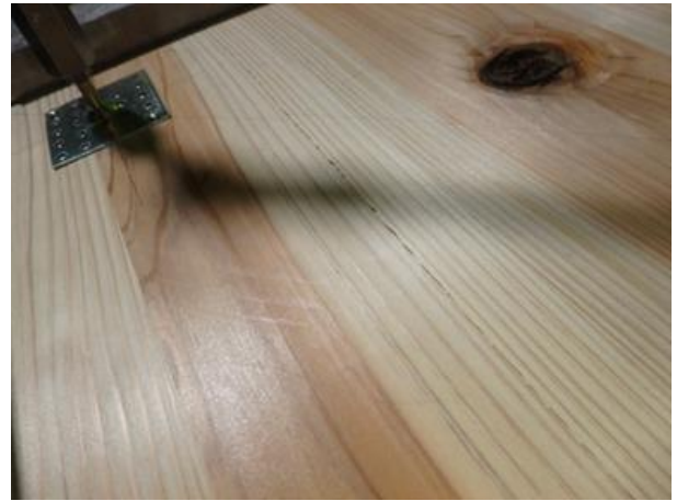
写真 3.3.3-4 試験体 S-01t 損傷状況 (ひび割れ部 3)
