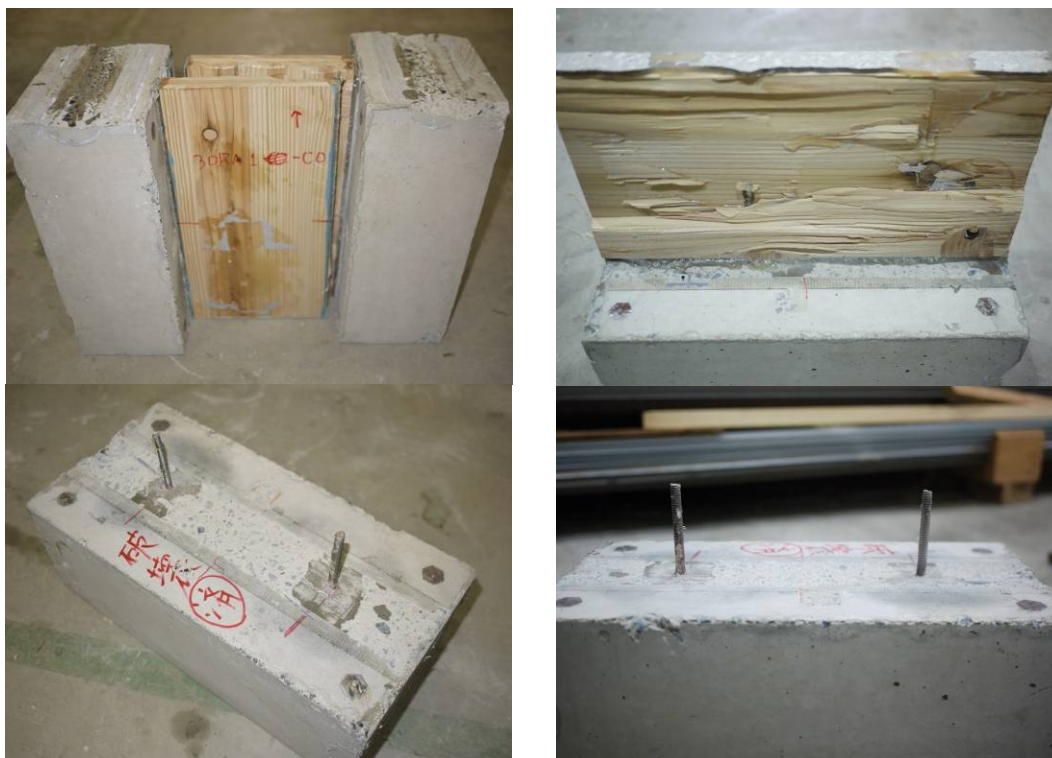
写真 3.2.3-3 30RA1-C0 破壊性状
