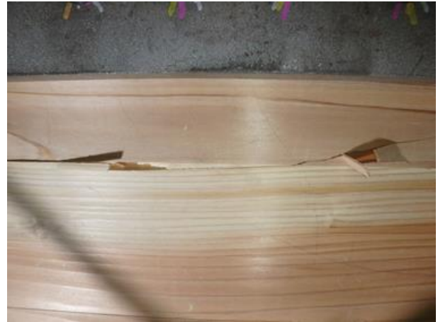
写真 3.3.3-2 試験体 S-01t 損傷状況 (ひび割れ部 1)
