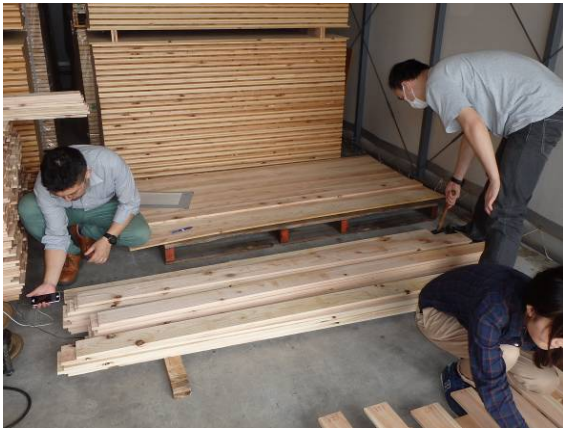
写真 3.1.1-3 縦振動の計測
