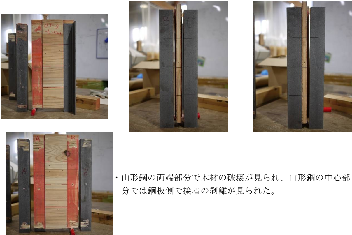
写真 3.3.3-4 L50-CLT-G 破壊性状
